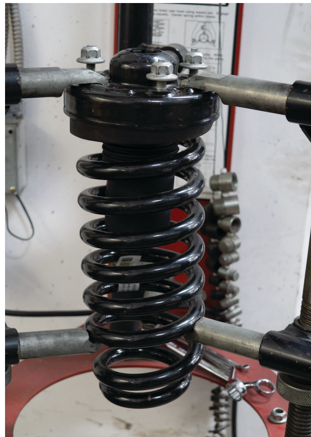
Fig. 9: Remove the center nut.
