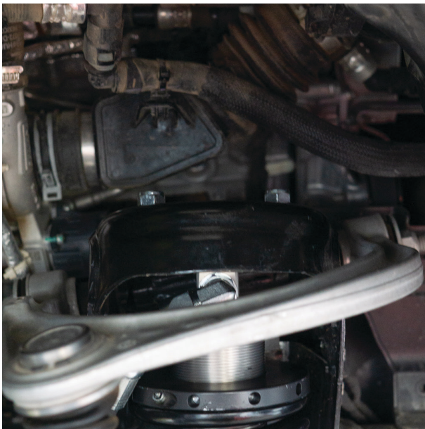
Fig. 14: Mount the top hat nuts.
